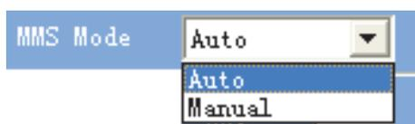
**SE VOLETE INSERIRE NELLA FOTOTRAPPOLA UNA SCHEDE SIM TIM O VODAFONE**, potete impostare **MMS MODE "AUTO"**, inserite nel campo COUNTRY "ITALY" e nel campo OPERATORS "TIM" o "VODAFONE". Inserite il vostro numero di telefono in PHONE NUMBER e la vostra email. Potete inserirne fino a tre.
