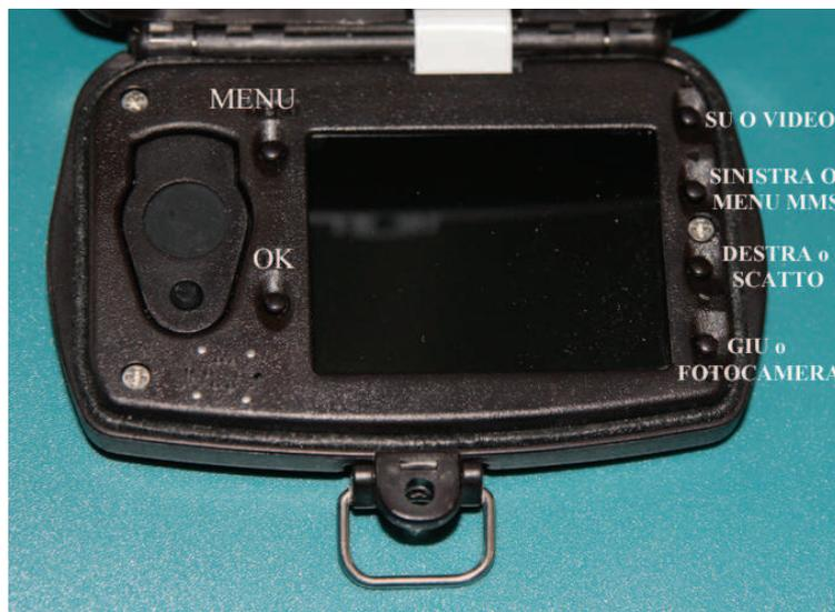
Accendete la fototrappola in posizione TEST. Potrete accedere al menù premendo il tasto MENU.
